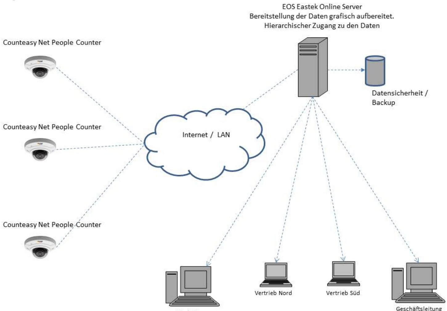
Die Kameras lassen sich bei der Installation auf den Daten Push einstellen. Die Zählraten werden dann in regelmäßigen Abständen auf die hinterlegte Domain gepusht.
