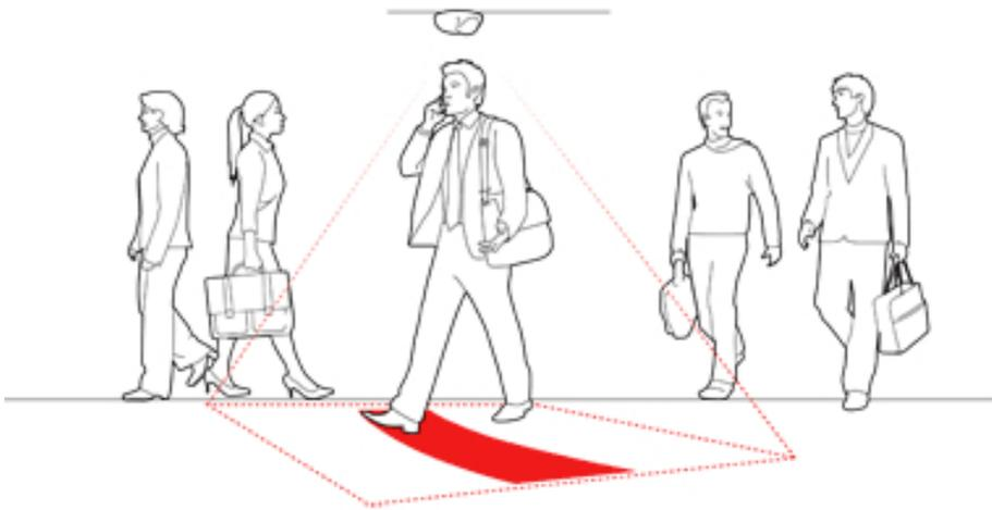
Für den Betrieb der Sensoren wird ein Netzwerkanschluss / Netzkabel benötigt. Die Spannungsversorgung erfolgt durch POE.
